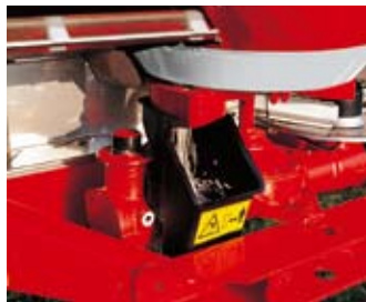
在搅拌器处于工作的状态下 打开出肥口
